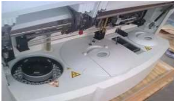
صورة (٤): الجهاز المستخدم لإجراء تحاليل السيستاتين C (Nephelometer)
