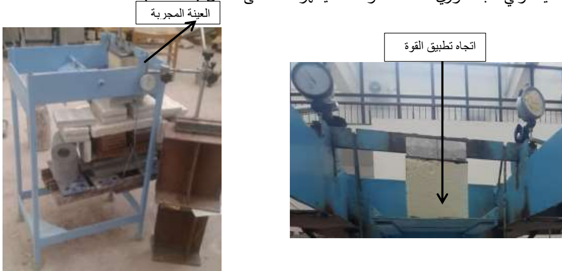
الشكل (٢-a): نموذج العينة سماكة ١٠ سم المختبرة مع نظام تجريب ضغط العينة
