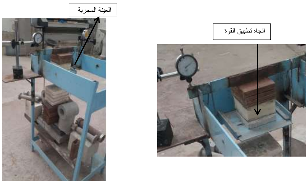
الشكل (2-b): نموذج العينة سماكة ٥ سم المختبرة مع نظام تجريب ضغط العينة
