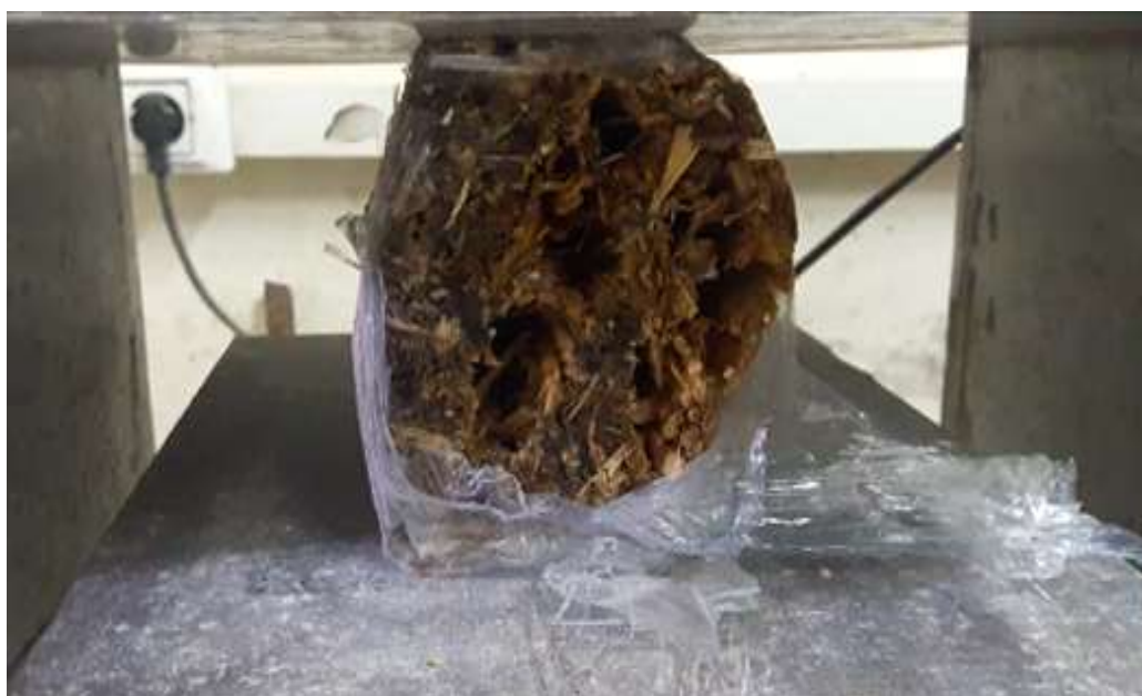
الشكل (10): شكل العينة ( 20 \text{ cm} \times 12 \text{ cm} \times 4 \text{ cm} ) بعد تعرضها للضغط بالشكل العامودي
