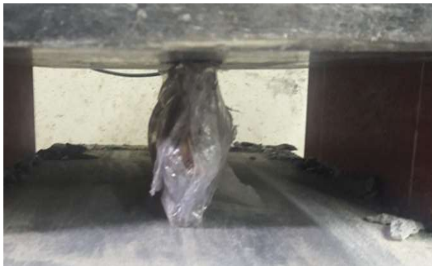
الشكل (12): شكل العينة (20cm×12cm×2cm) بعد تعريضها للضغط بالشكل العمودي
