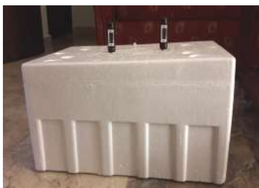
الشكل (7-b): طريقة وضع الموازين لقياس درجة الحرارة.
