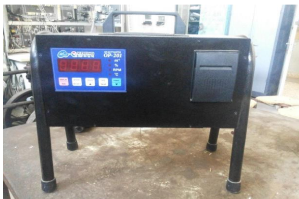
الشكل (٣) : جهاز قياس الضبابية والدخان
