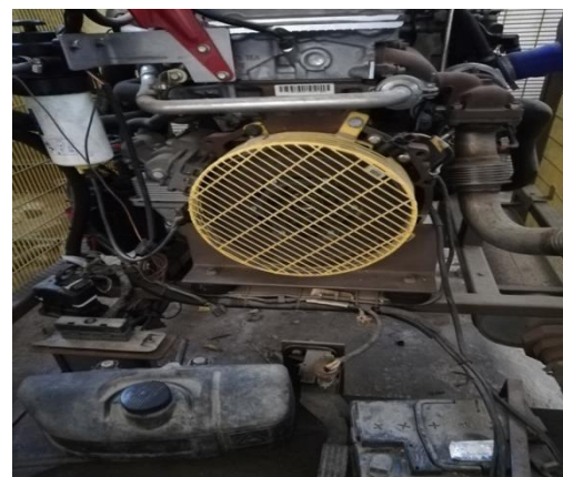
الشكل (١) : محرك ديزل رباعي الأشواط (FORD ZSD-424)
