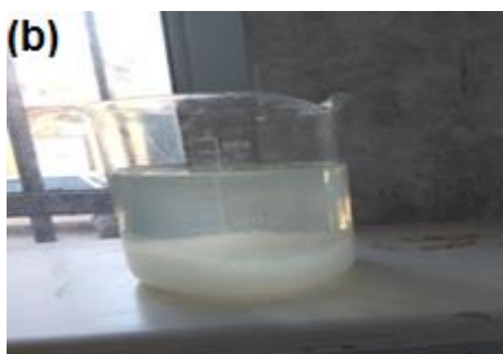
الشكل(2): ترشيح المحلول (a) ، تشكل هلام السيليكا (b)
