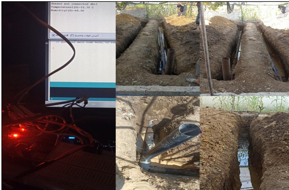
الشكل (3) يبين كيفية حفر الخنادق وتمديد قسم من الأنابيب التي تم تجربتها وتوصيل الحساسات مع الأوردينو والحاسب وأخذ القراءات
