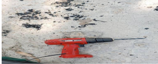
الشكل (7): المثقب المستخدم في عملية التنقيب.
