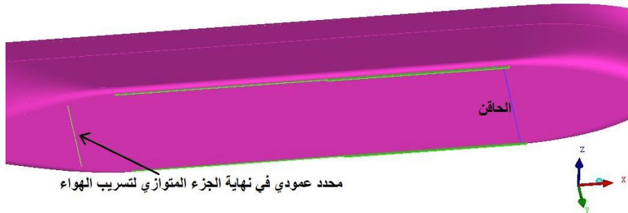
الشكل ١٩: محدّد عمودي على اتجاه التدفق في نهاية القسم المتوازي من أجل تسريب الهواء قبل دخوله إلى منطقة عمل الرفاص.
