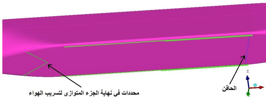
الشكل ٢١: محدّدات على شكل حرف V في نهاية القسم المتوازي من أجل تسريب الهواء قبل دخوله إلى منطقة عمل الرفاص.
