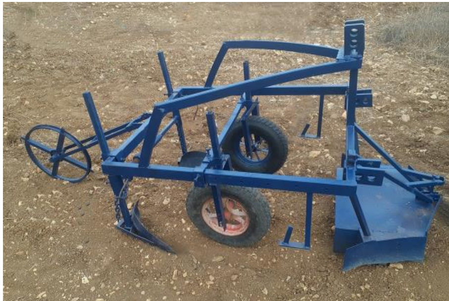
الشكل (٢) آلة فرش الملش البلاستيكي المصنّعة محلياً بعد التعديل
