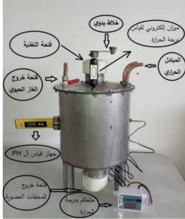
الشكل (٢) المفاعل الحيوي المخبري المصنع محلياً.
