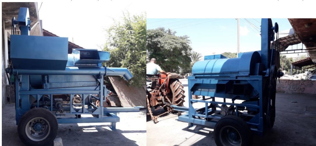
الشكل (4): وحدة دراس مماسية التغذية محورية التدفق المستخدمة في البحث
