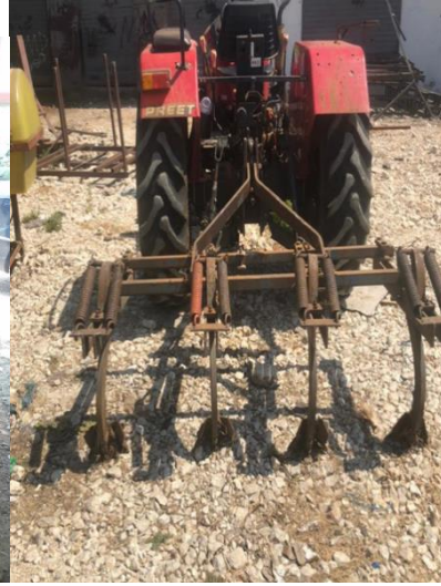
الشكل (٢): نظام حراثة حفارة بمحراث
