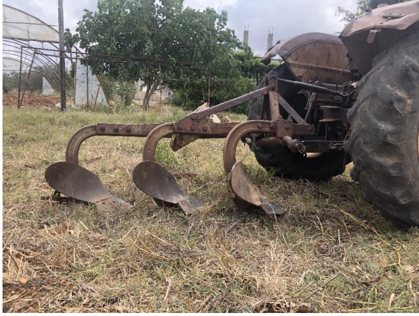
الشكل (١): نظام حراثة مطرحية بمحراث ثلاثي الأبدان وجرار نيو فرسال ٤٥
