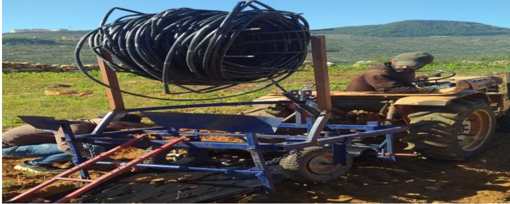
الشكل (8): آلة فرش الملش البلاستيكي ومد أنبوبة التنقيط
